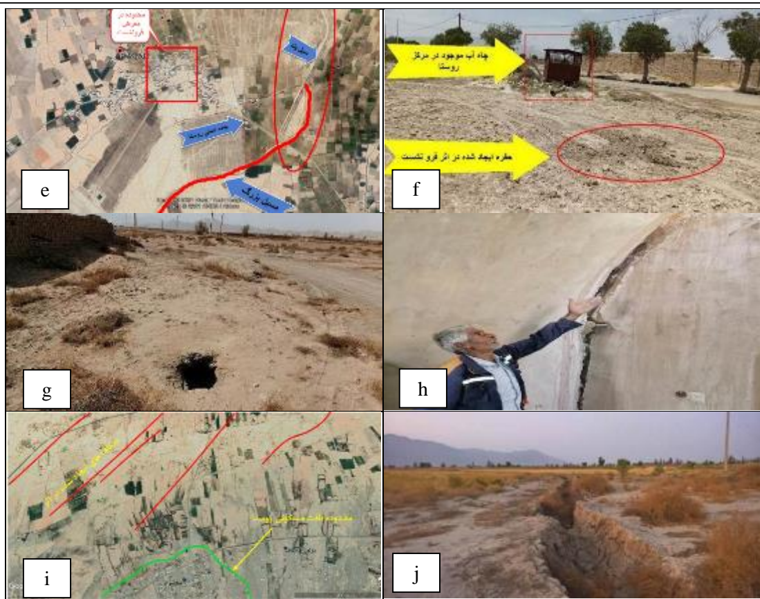
شکل ۹: a, b, c و d: شکاف ها و فروچاله ناشی از فرورانش زمین در روستای یزدل، e, f: موقعیت منازل آسیب دیده و شکاف ها و فروچاله ناشی از فرورانش زمین در روستای فاویان، g و h: ترک خوردگی ساختمان و فروچاله ناشی از فرورانش زمین در روستای ده محمد رفیع، i: موقعیت شکاف های ناشی از فرورانش زمین در اطراف روستای سفیدمراد، j: تصویری از شکاف ناشی از فرورانش زمین در اطراف روستای سفیدمراد
